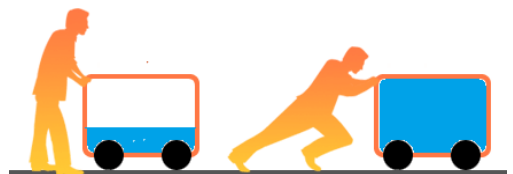
Fig. 3.11. Veprimi në dy rezervuar me ujë me masa të ndryshme.
