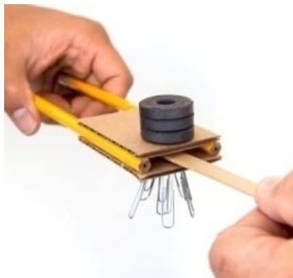
Fig. 7.30. Fusha magnetike depërton pllakën e drurit.
