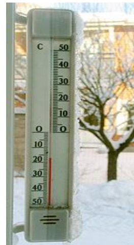
Fig. 6.18. Termometri për matjen e temperaturës ditore të ajrit.
