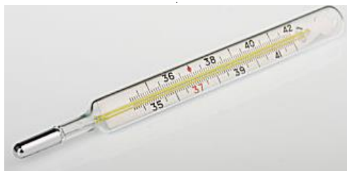
Fig. 6.14. Termometri me merkur.
