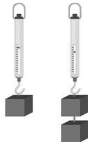
Fig. 3.19. Veprimi i trupave në peshoren me spirale.
